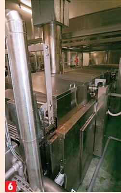
3 バッチ式の圧力釜ですりつぶした大豆を煮込む。煮沸曲線の描き方を見ながら、蒸気のパルプを微調整し炊き上げる／4 搾り機で豆乳とおからに分離する／5 温度を徐々に上げ、およそ50分かけて固めていく／6 大型フライヤーで揚げる／7 トンネルフリーザー®で冷却する／8 トンネルフリーザー®出口の品温は10℃以下／9 金属検出機に通し金属異物の有無をチェック
